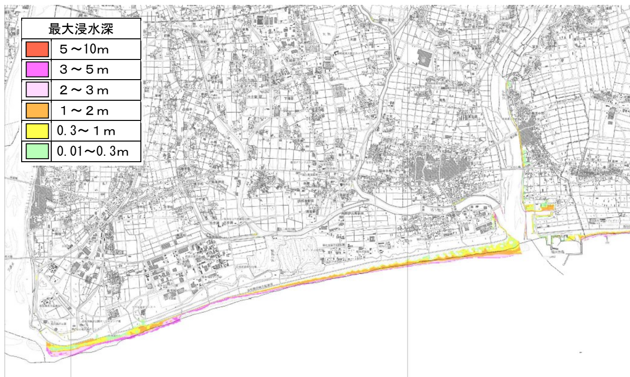
図2-1 東海・東南海・南海地震（レベル1）の津波浸水想定区域図
