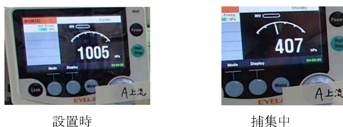
図 3 上流側ニードルバルブ操作時の捕集カラム 1 段目付近圧力
