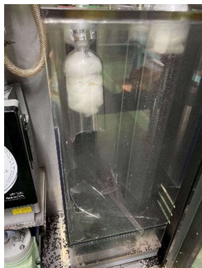
写真1 カラムの破損状況
