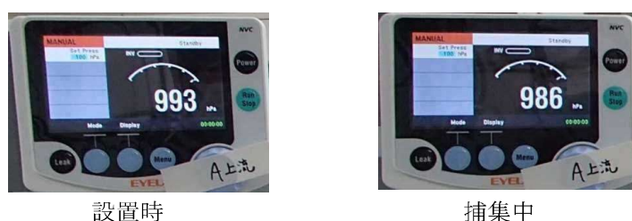
図 2 下流側ニードルバルブ操作時の捕集カラム 1 段目付近圧力
