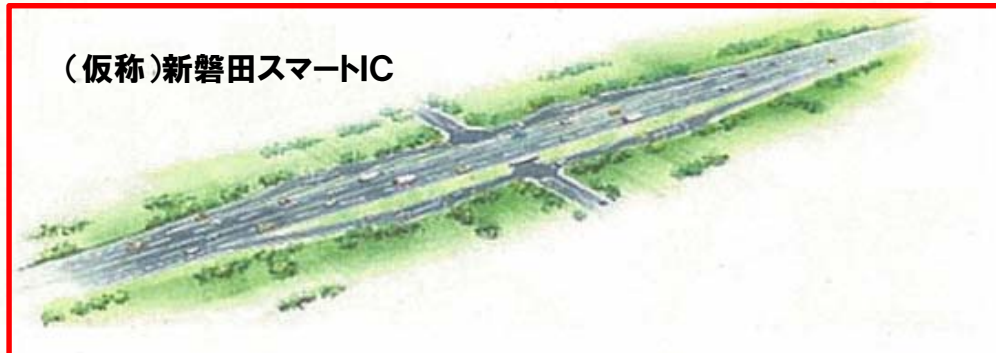
〔本線直結型〕 高速道路本線と一般道路を直接接続するもので、 主要道路との交差箇所などに設置するものです。
