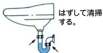
洗面器のつまり
