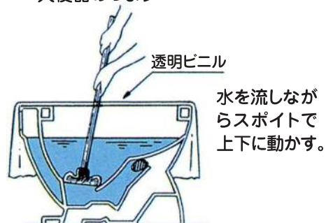
大便器のつまり
