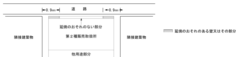
第16－3図 延焼のおそれのある壁又はその部分及び延焼のおそれのない部分の例
