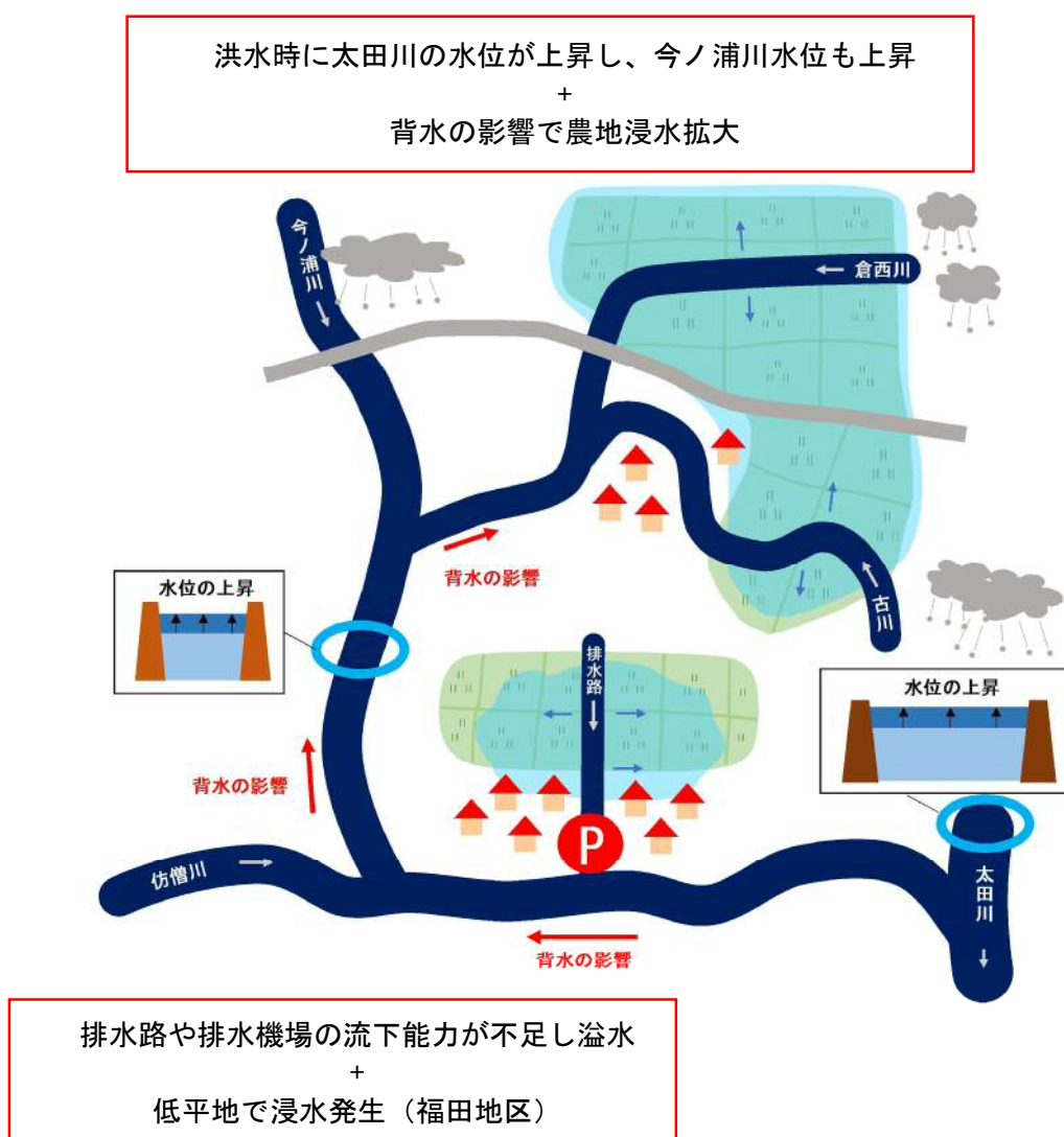
図 3-8 今ノ浦川流域の内水地区における浸水メカニズム
