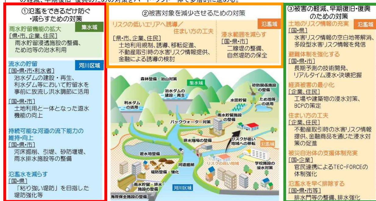
出典：「流域治水」の基本的な考え方（国土交通省 水管理・国土保全局）に加筆 図 5.4 流域治水の「3つの方向性」の概念図
