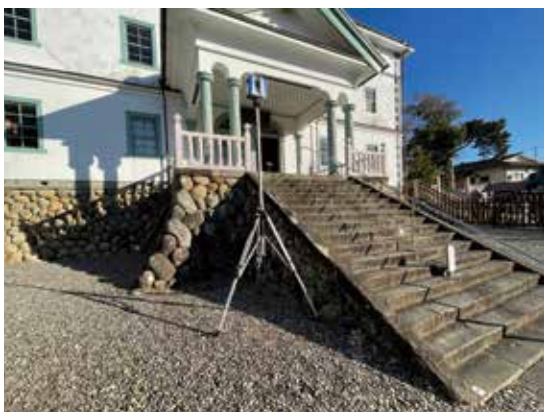
高所からのスキャン作業状況
